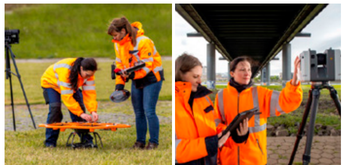
Links: Multicopter; Rechts: Laserscanner; Quelle: Ministerium des Innern NRW
